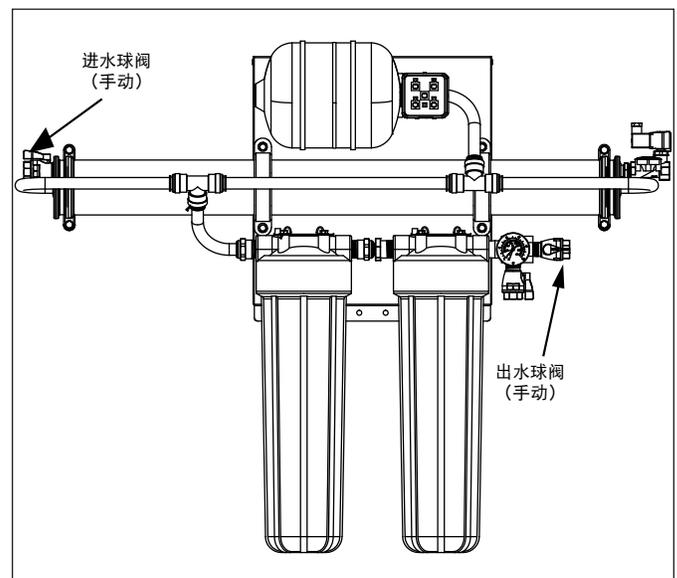
图 7. 进水管和出水管连接
